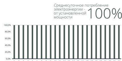
График потребления электроэнергии нерегулируемым воздуходувным оборудованием (не зависит от неравномерности поступления стоков).
