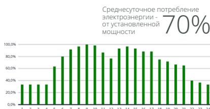
График потребления электроэнергии регулируемым воздуходувным оборудованием в соответствии с неравномерностью поступления стоков на КОС.
